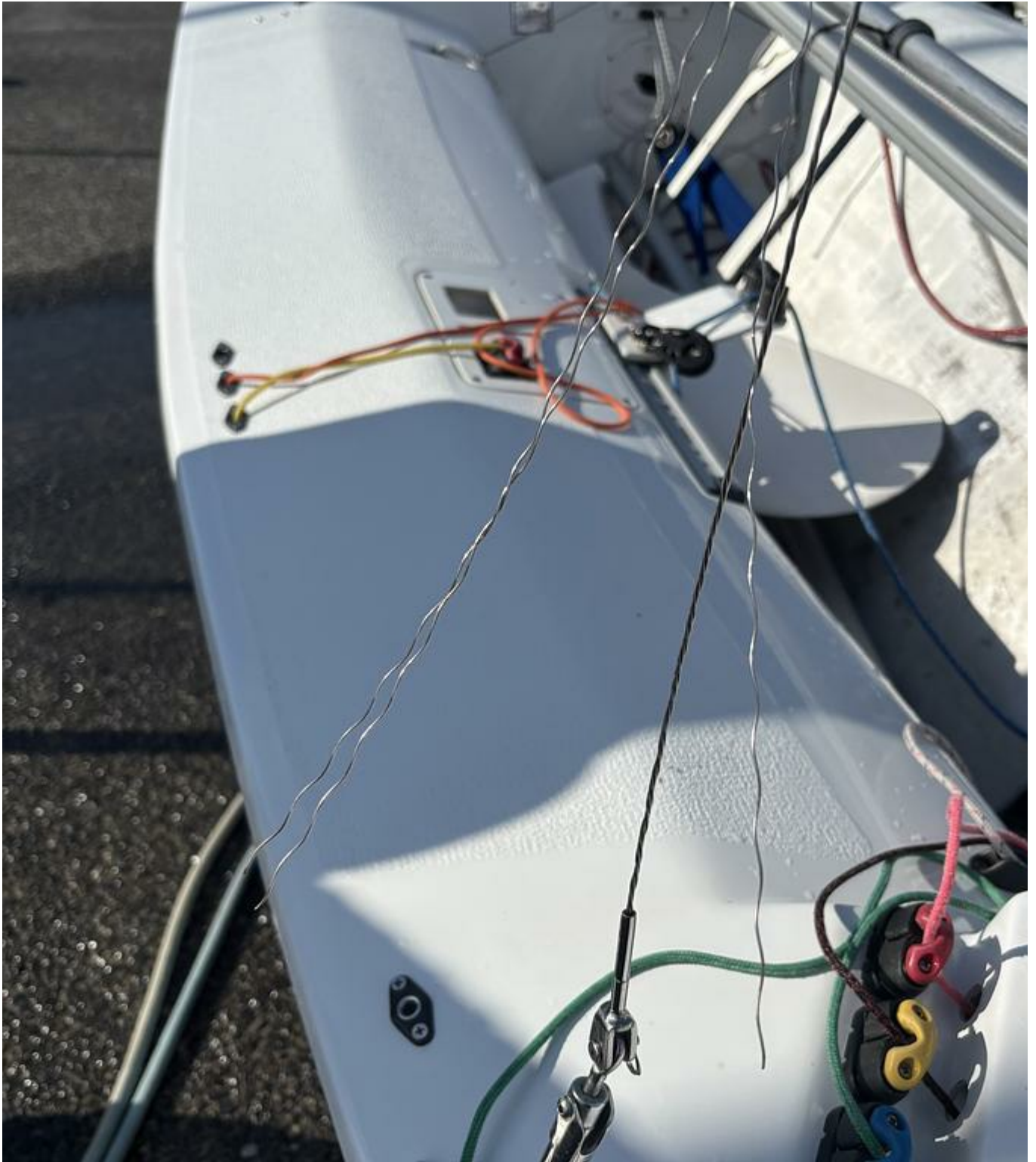
破損したサイドステイ
